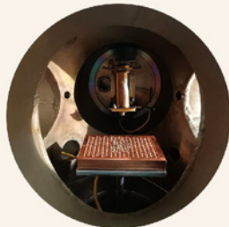
การนำเอาใส่เมล็ดกัญชาวาง ณ ตำแหน่งของ Target Holder
